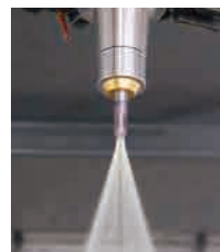
Kühlmittelzufuhr durch das Zentrum mit PS-Ring
