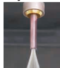
Kühlmittelzufuhr durch das Zentrum mit PS-Ring
