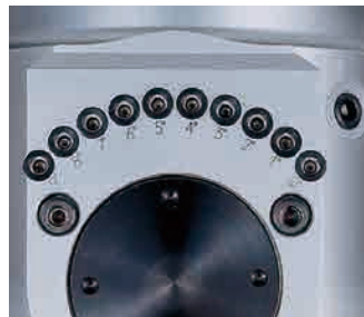
Einzigtiger Einstellmechanismus ermöglicht es, dass der Spindelwinkel mit 1° - Schritten genau eingestellt werden kann.
