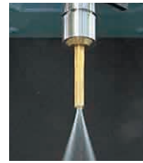
Kühlmittelzufuhr durch das Zentrum mit PS-Ring
