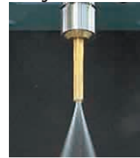
Kühlmittelzufuhr durch das Zentrum mit PS-Ring
